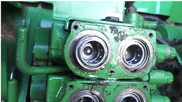
Ejemplo de terminal de acople hidráulico en zona de diferencial del tractor. Puede variar según el modelo del mismo.
