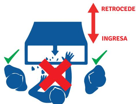
**12- Puede comenzar a operar el equipo.** Siga las recomendaciones para el ingreso de material (por ej., siempre de costado, nunca de frente). Utilice la barra roja para controlar el ingreso del material, tirando de la misma hacia Ud.. Si el material se atasca, puede retroceder empujando la barra roja en sentido opuesto. Puede utilizar la manija de enclavamiento central (roja) para que la alimentación sea continua.
