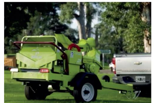
**6- Vehículo de remolque.** Si es necesario, enganche la punta de lanza con el perno y chaveta o dispositivo correspondiente, enganche cadenas reglamentarias, conecte instalación de luces de transporte reglamentarias y verifique funcionamiento de las mismas. Rebata el gato de lanza o rueda timonera para su transporte.
