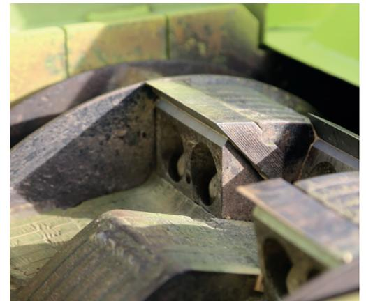
**5- Limpieza del equipo.** Con todas las capotas abiertas, se recomienda el uso de un soplador de mano de uso profesional o de aire comprimido para limpiar mediante chorro de aire todas las zonas del equipo, evitando la deposición de viruta o restos de material. Aproveche para una **INSPECCIÓN VISUAL** del equipo en todos sus partes. Recuerde utilizar protección facial para esta tarea.
