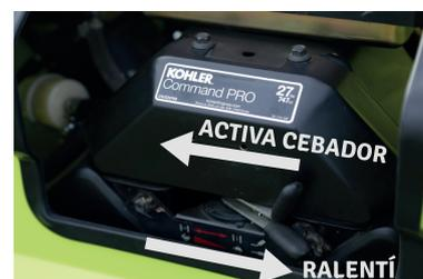
**10- Lleve el motor a régimen de trabajo.** Mueva la palanca del acelerador hacia la izquierda hasta que haga tope. Espere 10 segundos hasta que tanto el motor como el rotor de triturado entren en "régimen" (se dará cuenta de que tanto el sonido como la vibración general del equipo se "estabilizan").
