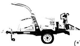
**CLASE DE EQUIPO** Chipeadora a tambor horizontal para ramas hasta 8" remolcable con motor a explosión
