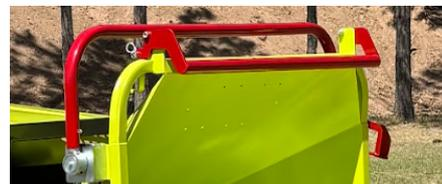
BARRA DE SEGURIDAD ANTI-PÁNICO INTEGRADA
