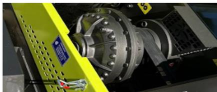
ACOPLE TRACCIÓN POR EMBRAGUE HIDRODINÁMICO
